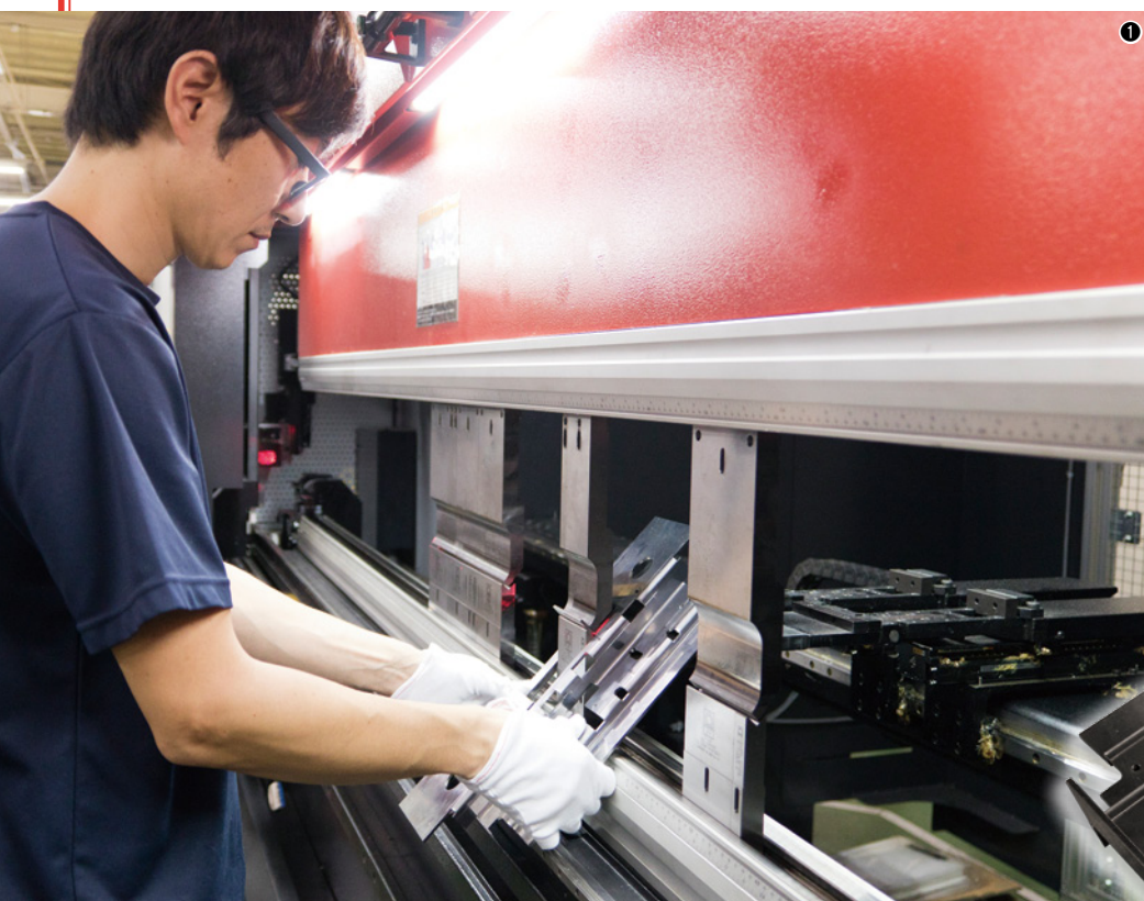
①自動金型交換装置付きベンディングマシンHG-1003ATCによる曲げ加工。曲げ12工程の製品をステップバンドで効率よく加工している／②HG-ATCのNC端末AMNC 3iで曲げ加工データを呼び出す／③HG-ATCで曲げ加工した高速道路・有料道路のETCゲート部品(12工程)
