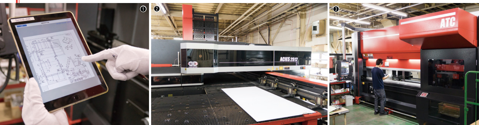
①現場のタブレット端末から図面データを閲覧できる／②ブランク工程にはパンチ・レーザ複合マシンACIES-2512T(写真)をはじめ3台の複合マシンを設備／③2016年に導入したHG-1003ATCでは、多品種少量の製品や曲げ工程数が多い製品、加工精度を求められる製品を優先的に加工している
